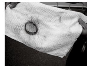
右が天然ガストラック、左がディーゼルトラックの排気口にタオルをかぶせたもの。天然ガス車は排気もきれい。
